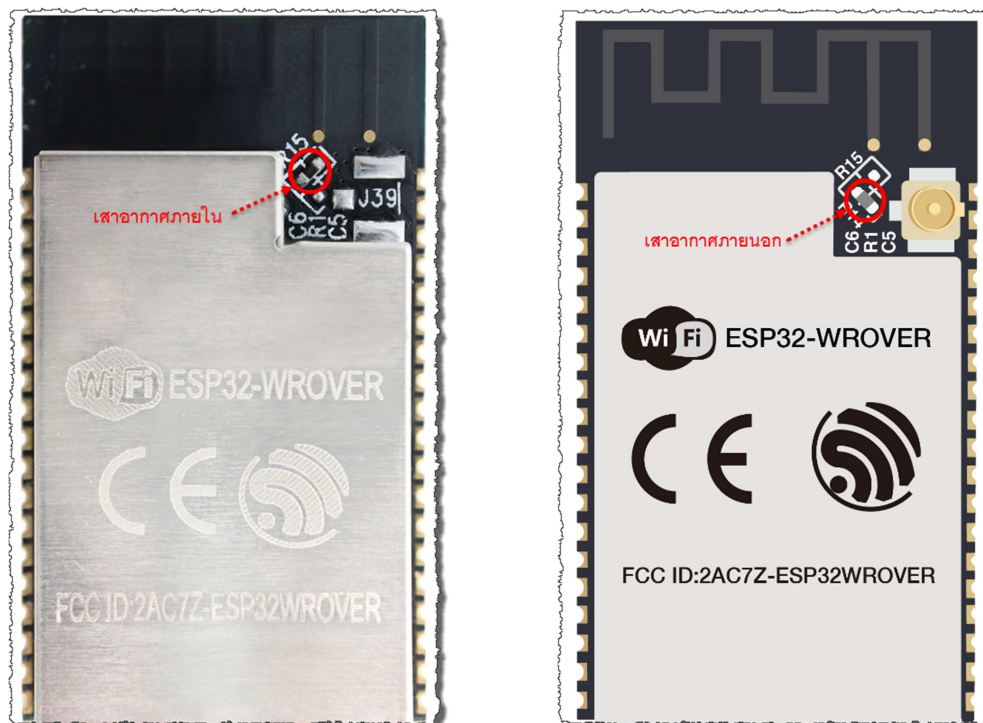
รูปแสดง การบัดกรี Jumper(R 0 โอห์ม) เพื่อเลือกใช้เสาอากาศภายในและภายนอก
